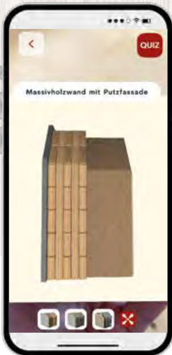
Massivholzwand mit Putzfassade
