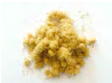
Holzfaserdämmplatten bestehen aus winzigen Holzteilen (= Holzfasern)
