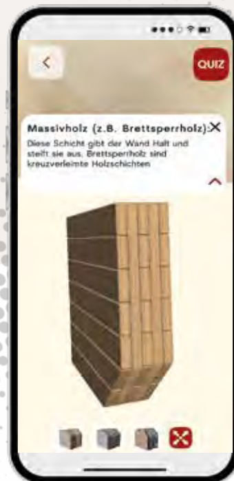
Kurzbeschreibung einer einzelnen Schicht (Beispiel „Brettsperholz“)
