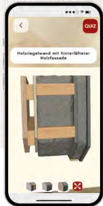
Holzriegelwand mit hinterlüfteter Holzassade
