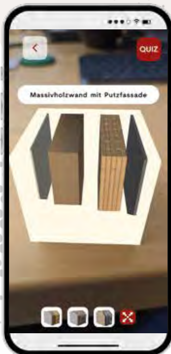
Die einzelnen Schichten der Wand (getrennt voneinander)
