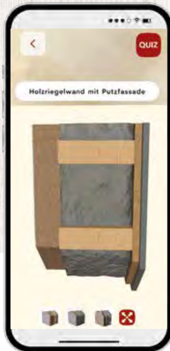
Holzriegelwand mit Putzfassade
