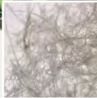
Papier in 8-facher Vergrößerung - die übereinander liegenden Fasern sind gut sichtbar
